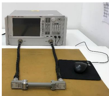
Figura 2 – Guia de ondas acoplado ao analisador de rede vetorial
